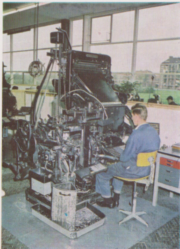
Het zetten op de zetmachine gaat belangrijk sneller dan het zetten met de hand
